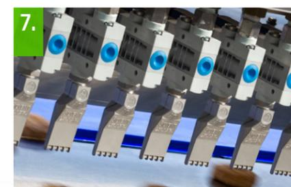
**Soffi d'aria per scarto del singolo prodotto** (la presenza di un serbatoio dell'aria garantisce la costanza di portata e pressione agli ugelli).
