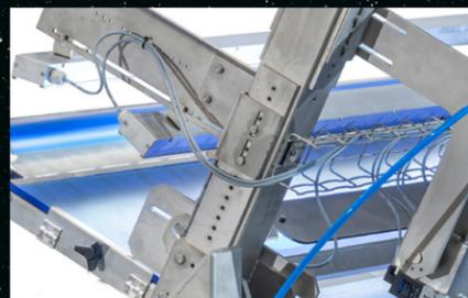
**Struttura in acciaio inox** compatta e modulare (la modularità del sistema permette di integrare i nuovi tipi di controllo anche in momenti diversi).
